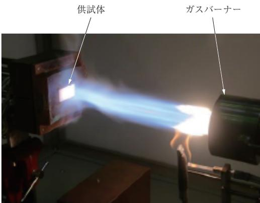
第 10 図 熱サイクル試験 試験形態
