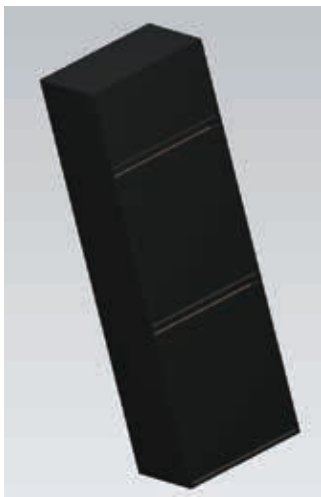
第 16 図 フェアリング搭載時のロール型デブリ除去衛星 Fig. 16 Roll-type ODR satellite in payload fairing
