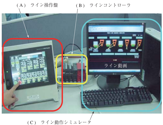
第6図 プレスライン動作シミュレータ Fig. 6 Press line sequence simulator
