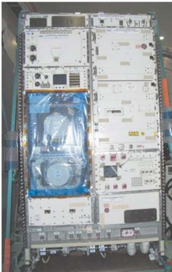
第3図 細胞培養実験装置用実験ラック
