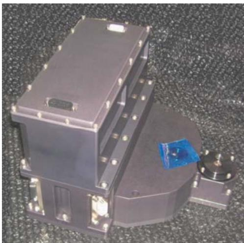
第 13 図 過冷凝固実験供試体Ⅱ型実験供試体
