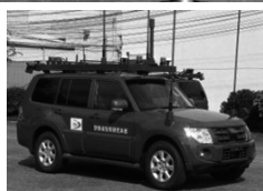
第2図 CBRN *1 対応遠隔操縦作業車両システム Remote controlled engineering vehicle system for CBRN *1 threat
