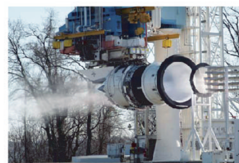
GEnxエンジンの雨霰吸込試験
