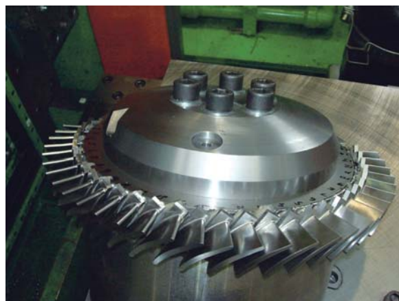
第 9 図 LFW 法で製作したブリスク試験体 Fig. 9 Demonstrator blisk manufactured by LFW
