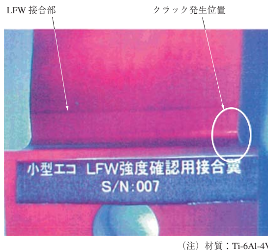
第 8 図 疲労試験後の翼形状試験片外観 Fig. 8 Appearance of blade shape sample after high cycle fatigue test
