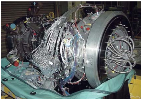
第3図 ベース形態高負荷多段圧縮機の外観
