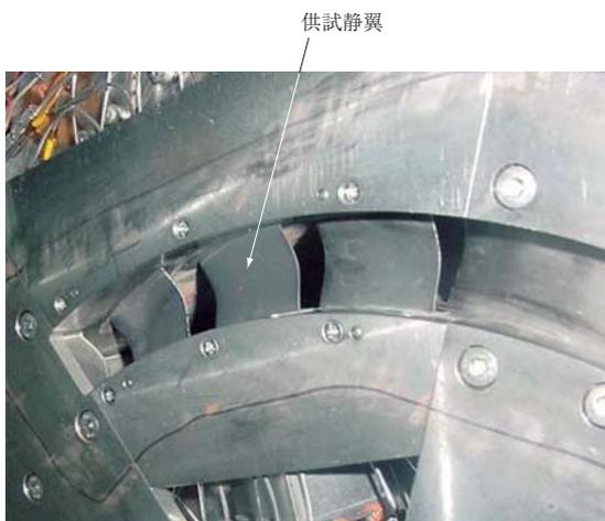
第 14 図 セクタ翼列試験装置
