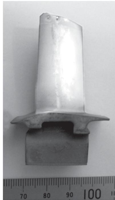
第 25 図 レーザ CVD で翼面に YSZ コーティングを形成したタービン動翼
