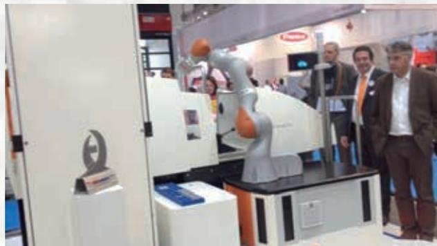
軽量ロボットによる工作機械へのワークセット (メーカー: KUKA) (ロボットが力制御でカバーを開閉)
