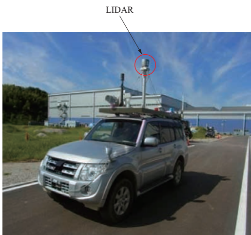
第 2 図 ロボット車両 Fig. 2 Appearance of robot car with LIDAR
