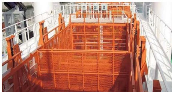
第4図 コンテナ昇降式ゴミ回収装置
