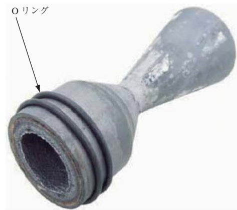
第 12 図 燃焼試験後の CMC ノズル外観 Fig. 12 CMC nozzle appearance after testing with hot gas
