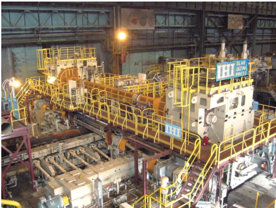
第 2 図 サイジングプレス本体 Fig. 2 Slab width sizing press
