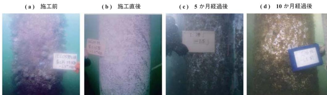
第14図 鋼管ぐい表面の外観
