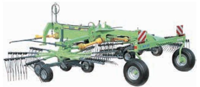
大型ジャイロレーキ TGR7310 (適応トラクター: 60 ~ 125 馬力)
