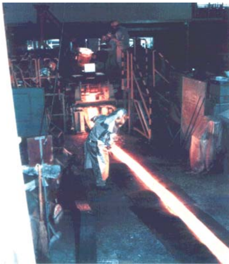
第 3 図 IHI でのストリップキャスト実験機 Fig. 3 Strip casting experiment at IHI
