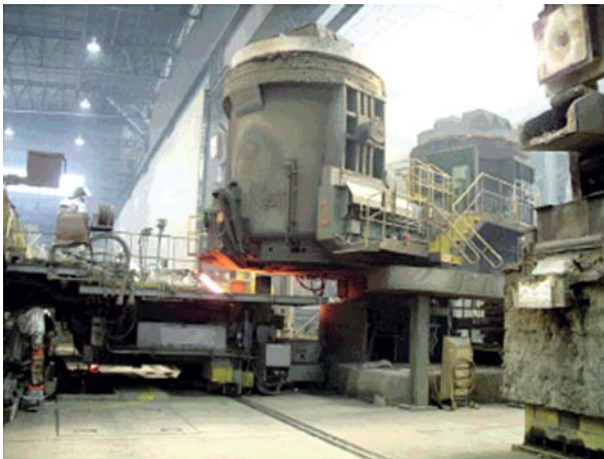
第 20 図 NUCOR 社クロフォーズビルの CASTRIP プラントでの鑄造中のレードル交換
