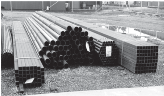
第 17 図 As cast 材から製作された電線管 Fig. 17 Electric welded pipes made from As cast strip
