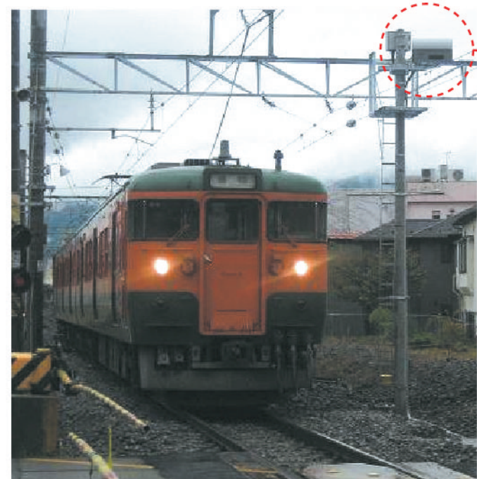
三次元レーザーレーダ式踏切障害物検知装置
