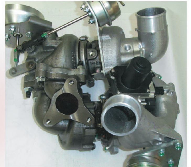
2段過給(2台のターボを使う)システム
