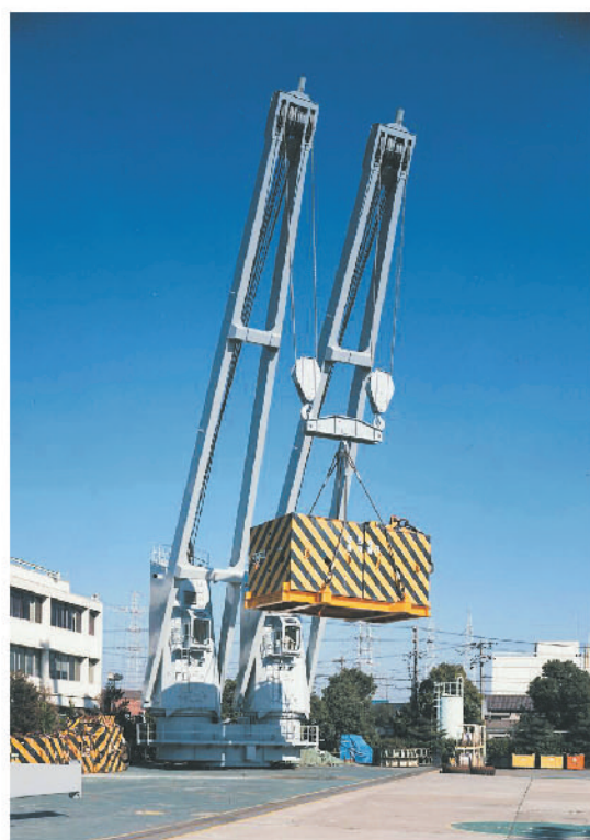
120トン吊りダブルクレーン
