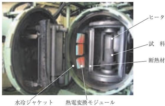
第10図 抵抗加熱式工業炉への適用概念
