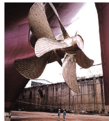
VLCC (超大型タンカー) 「沖ノ島丸」のCRP
