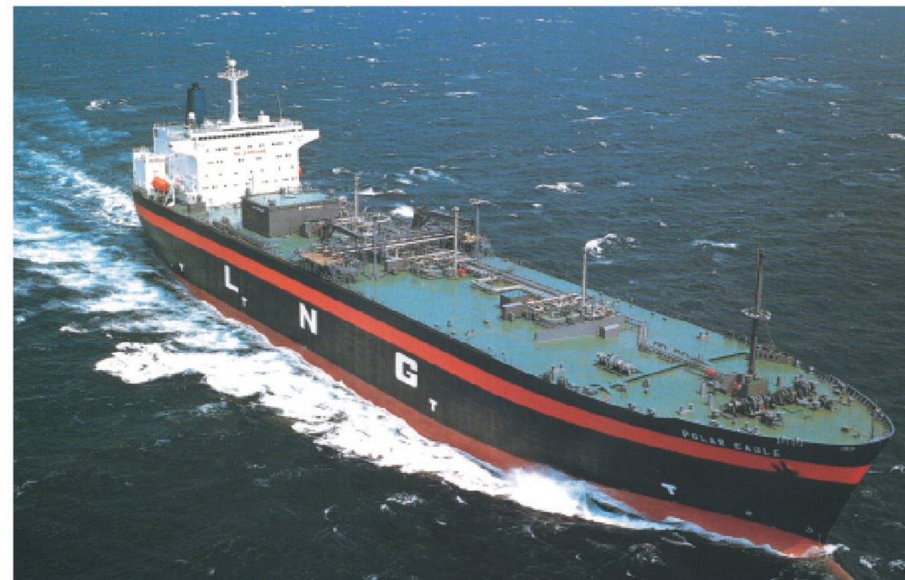
世界初のSPB方式LNG船Polar Eagle号（1993）
