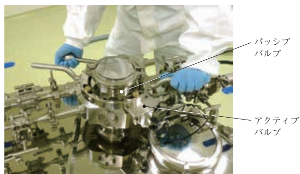
第3図 スプリットバタフライバルブ Fig. 3 Split Butterfly Valve (SBV)
