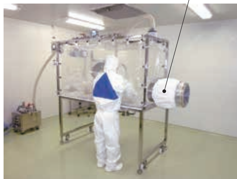
第2図 フレキシブルアイソレータ Fig. 2 Flexible isolator
