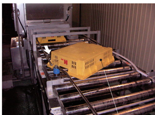
第6図 コンベヤ(はく離機後転換)
