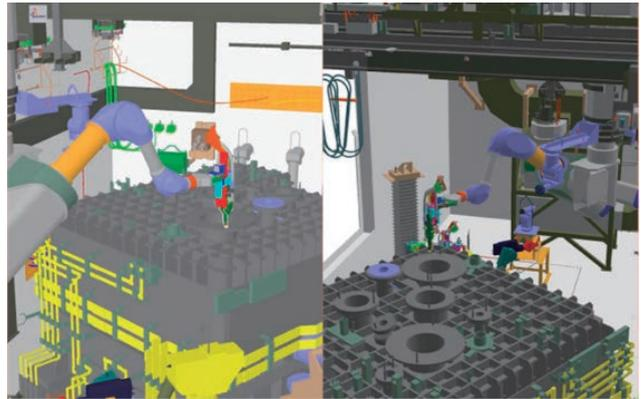
3D-CAD を用いた遠隔操作シミュレーション
