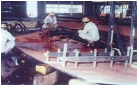
第1図 線状加熱曲げ加工 Fig. 1 Line heating
