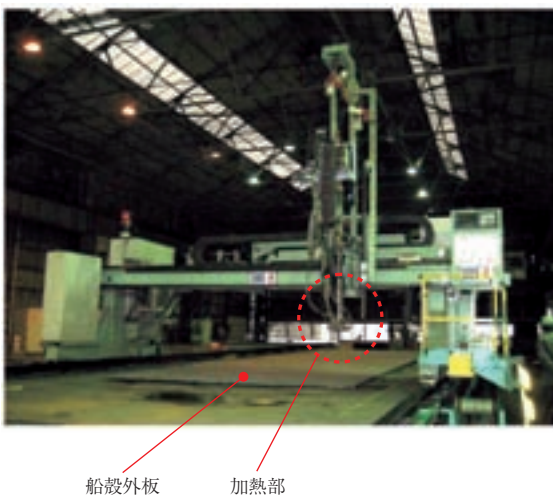
第 3 図 線状加熱自動鋼板曲げシステム (IHI- \alpha ) Fig. 3 IHI-ALPHA system
