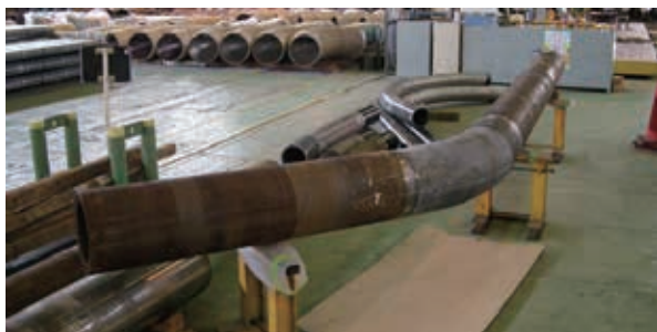
高周波曲げをした Ni 基合金大径管
