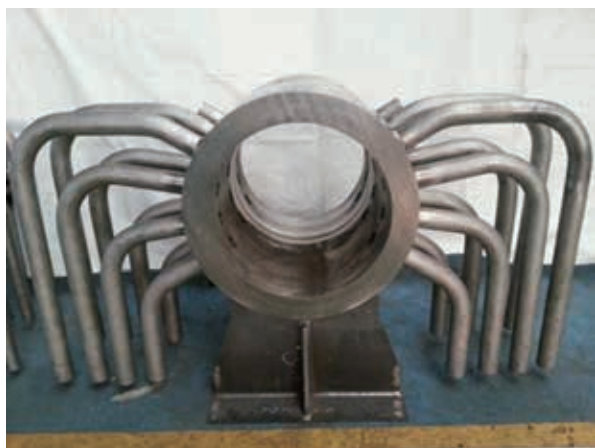
Ni 基合金再熱器管管寄せ
