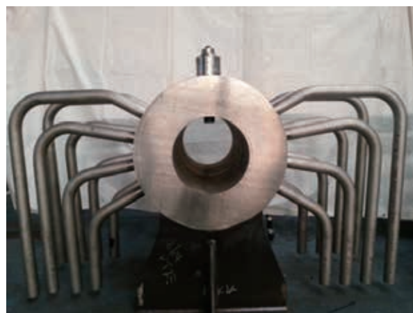
Ni 基合金過熱器管管寄せ
