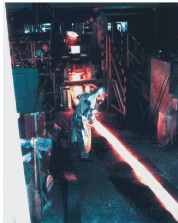
IHI研究所での200幅ストリップ鑄造テスト
