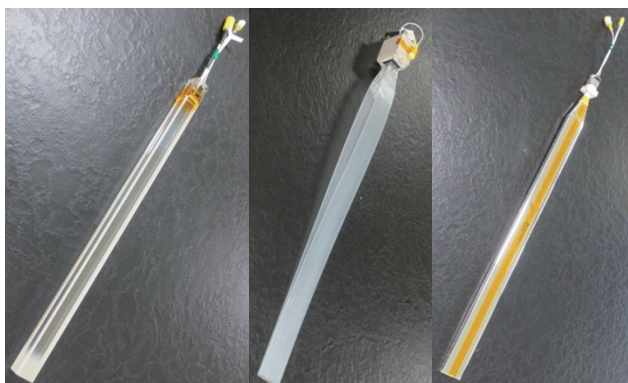
左：全吸収型カロリメーターセンサー（タングステン酸鉛結晶シンチレーター） 中：イメージングカロリメーターセンサー（シンチレーションファイバー） 右：電荷測定器センサー（プラスチックシンチレーター）
