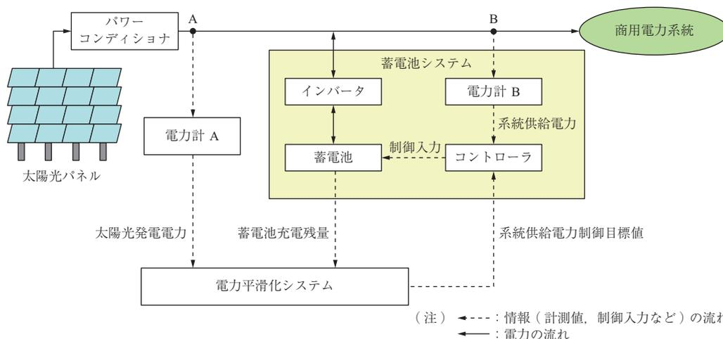
第1図 蓄電池が併設されたメガソーラーのシステムモデル
