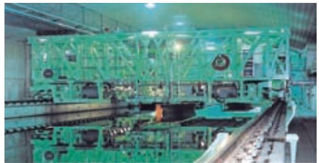
第 11 図 船型試験水槽
