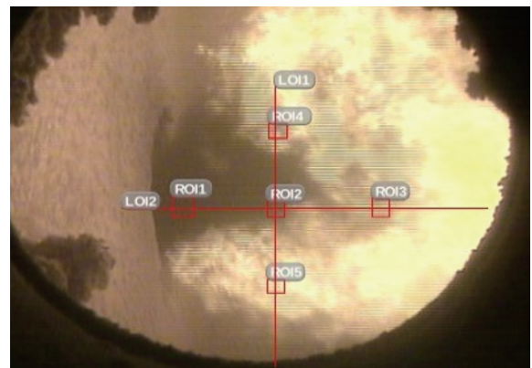
熱量比 20% のアンモニア適用時における火炎の様子
