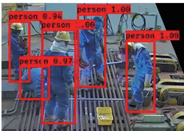
天井カメラによる人検知（人検知機能） （IHI 相生工場 製造部に実施）
