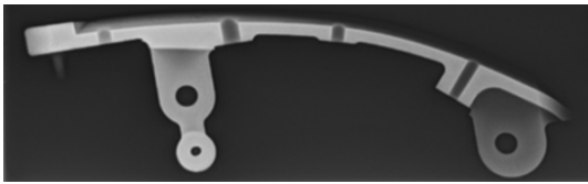
第 11 図 複合材ファン静翼締結部品 X 線検査結果 Fig. 11 X-ray inspection results of Structural Guide Vane support
