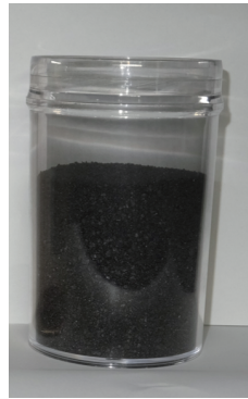
第3図 鉄鉱石と天然ガス熱分解によって鉄鉱石の表面に析出した炭素
