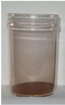
第3図 鉄鉱石と天然ガス熱分解によって鉄鉱石の表面に析出した炭素
