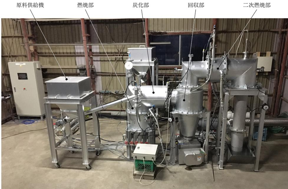
部分燃焼高速炭化方式（2 t/d 試作機）
