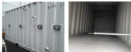
(b) 温度計取付け状況（左：外面、右：内部）
