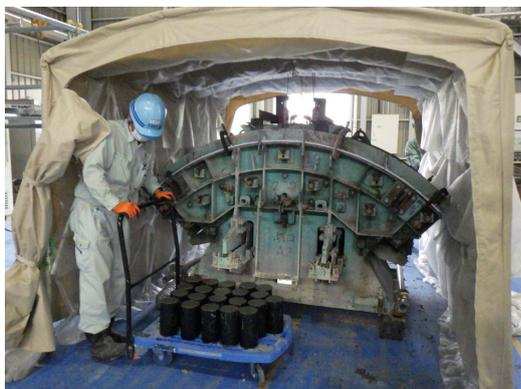
第10図 荷重試験体の試作（加温養生）
