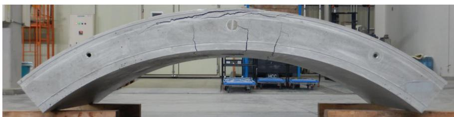
第14図 試験体のひび割れ状況
