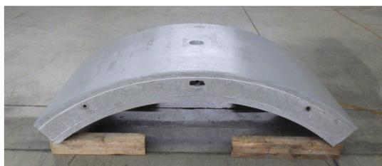
第11図 試作した荷重試験体
