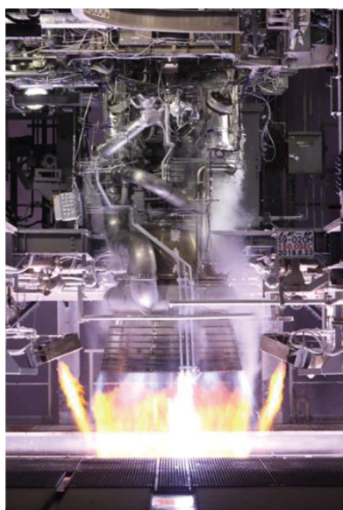
第 9 図 LE-9 エンジン燃焼試験 (4) Fig. 9 LE-9 engine hot firing test (4)
