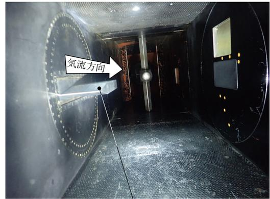
くさび状ジグの表面に搭載された供試体
