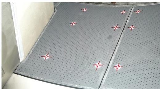
第8図 JAXA F7 エンジンに搭載した樹脂製軽量吸音ライナ
