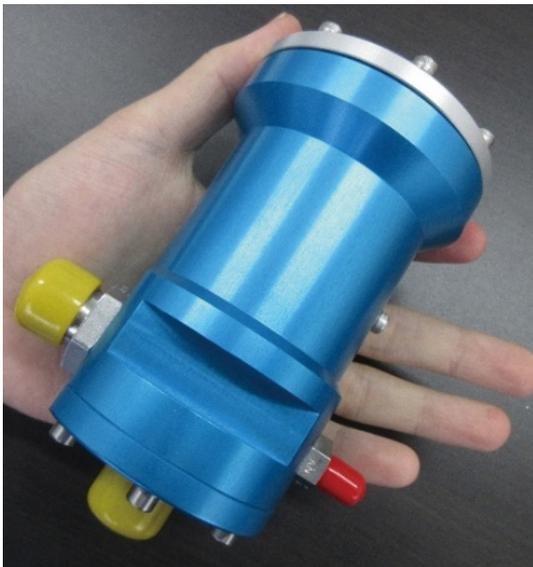
試作した低コスト空圧弁の外観
