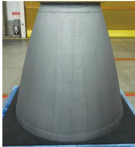
試作した複合材ノズルの外観
