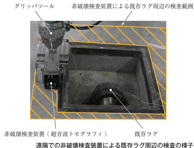
遠隔での非破壊検査装置による既存ラグ周辺の検査の様子
