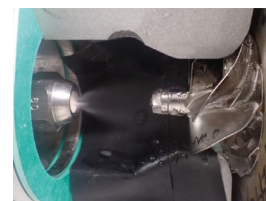
(a) 凝縮水をコンプレッサーインペラに噴霧する様子
