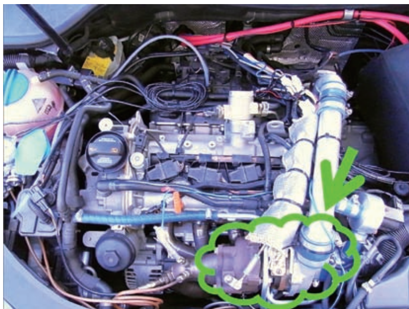
電動アシストターボチャージャ搭載試験車両のエンジンルーム
