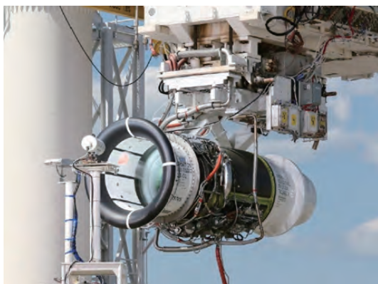
(a) 氷塊打ち込み試験
