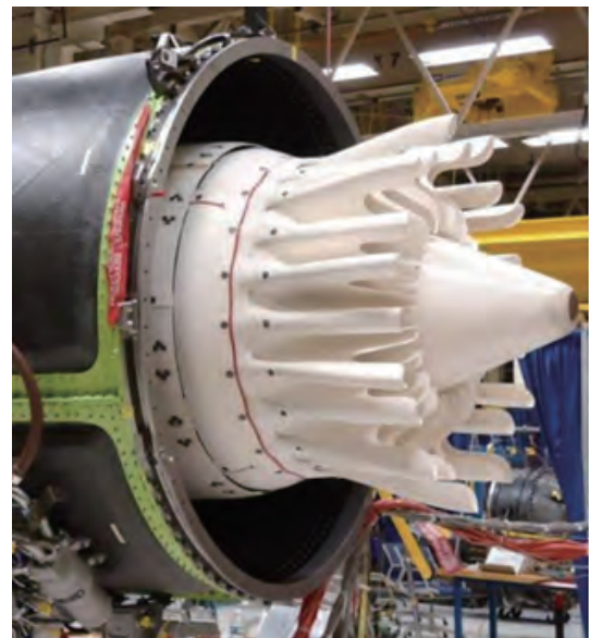
第 11 図 CMC ミキサノズル Fig. 11 CMC mixer nozzle
