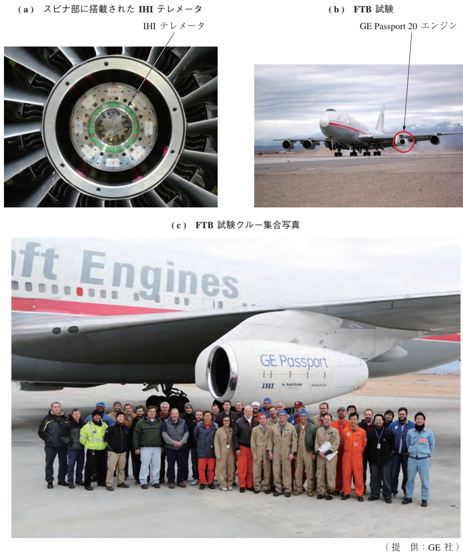
第 12 図 IHI テレメータ搭載の FTB 試験 Fig. 12 Flying Test Bed test with IHI telemeter
