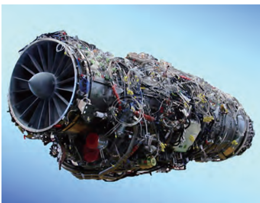
第 1 図 XF9-1 エンジン外観 (1), (3) Fig. 1 External view of XF9-1 engine (1), (3)
