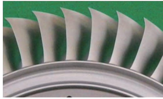
第 6 図 圧縮機要素供試体動翼形状 (4), (5) Fig. 6 Compressor blade of test rig (4), (5)
