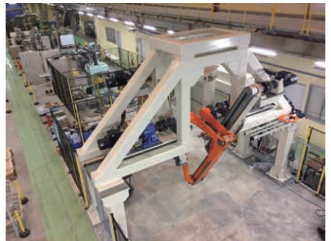
本宮工場で開発中の世界最速（23 枚／分）大型プレス間搬送装置（X-Feeder）
