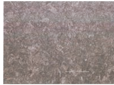
SCr420H ミスト冷却後の組織
