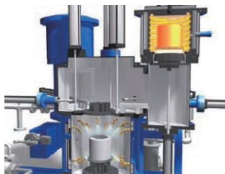
加熱とミスト冷却の様子
