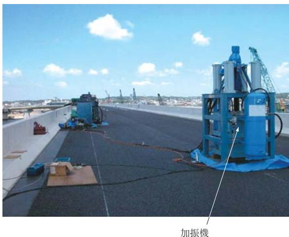
第 11 図 加振試験の状況
