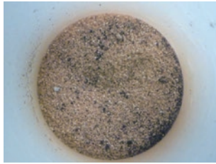
(a) Run1 *1 試験後の流動床 (アグロメレーションなし)
