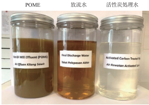
第 17 図 POME 処理プロセスによる排水浄化 Fig. 17 Photograph of treatment by each IHI process
