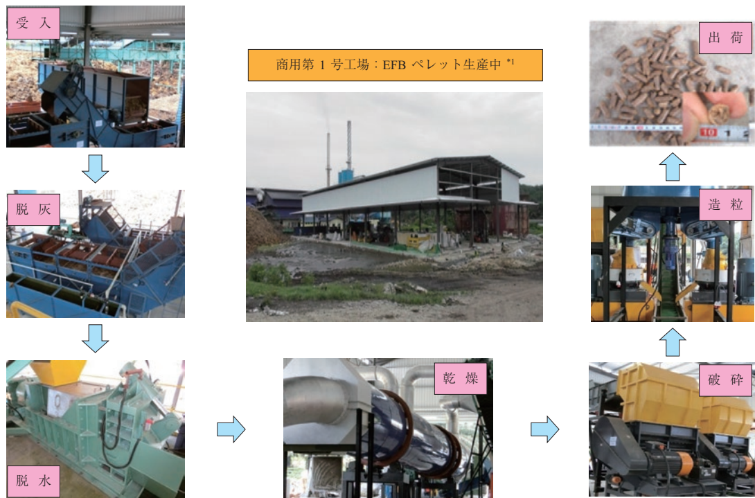
第3図 EFBペレット製造プロセス Fig. 3 EFB pellet manufacturing process
